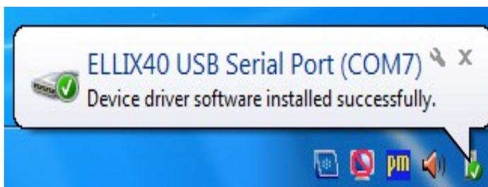
6. Когда установка будет завершена, запустите "Диспетчер устройств" для проверки номера нового виртуального COM порта
