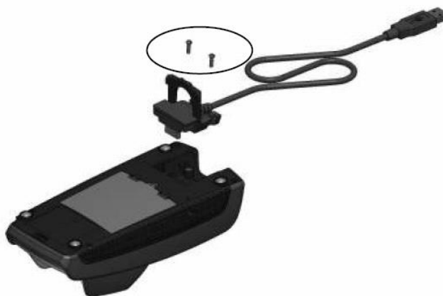
Рис. 2 Закрепление разъема
