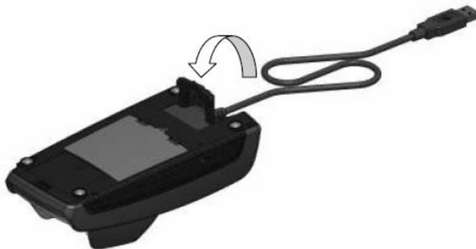
Рис. 5 Отсоединения кабеля
