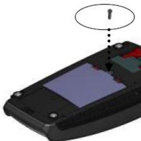
Рис. 7 Установка модуля считывания бесконтактных карт 3
