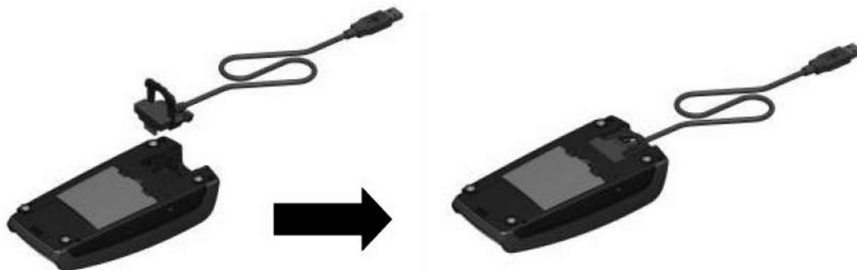
Рис. 3 Подключение кабеля
